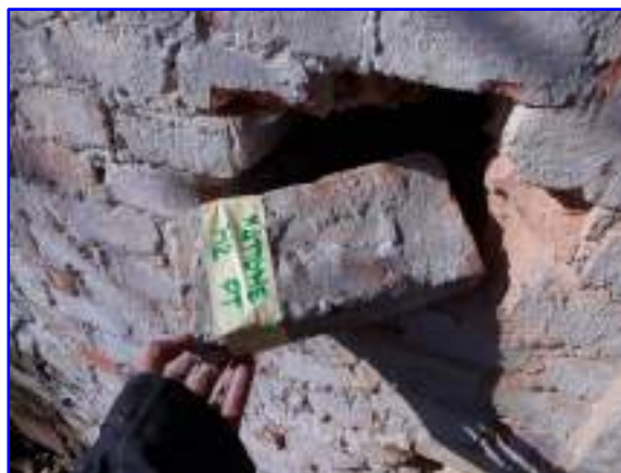
Prelievo campione M2 – piano terra
