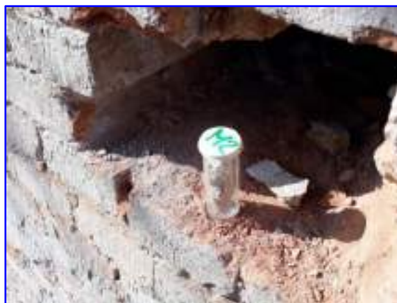
Prelievo campione Ma2 – piano terra
