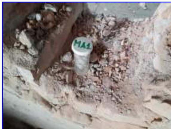
Prelievo campione Ma1- piano primo
